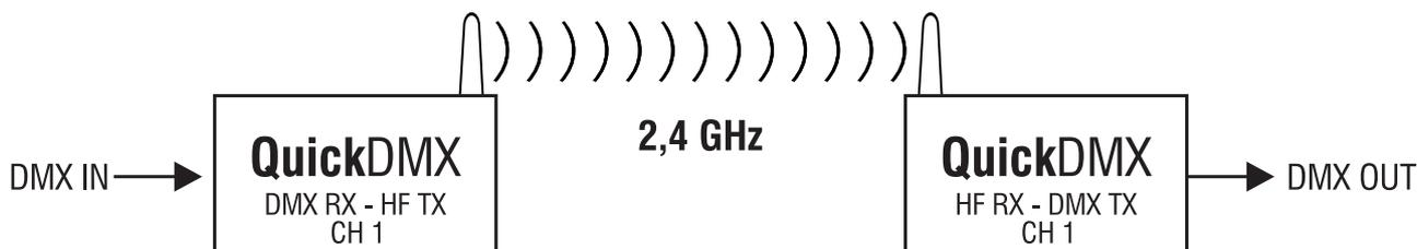
Das DMX-Signal wird bei einem Sender eingespeist und von diesem per HF gesendet. Ein Empfänger mit identischem Übertragungskanal empfängt das HF-Signal und gibt es als DMX-Signal aus.
